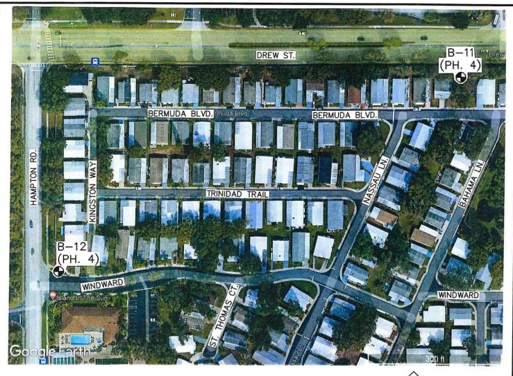
STANDARD PENETRATION TEST BORING/ HAND CONE SOUNDING LOCATION
